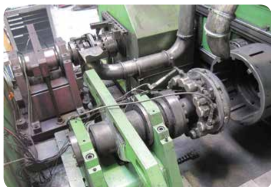
Vue des deux postes de freinage instrumentés : compétition (Formule 1) et aéronautique
